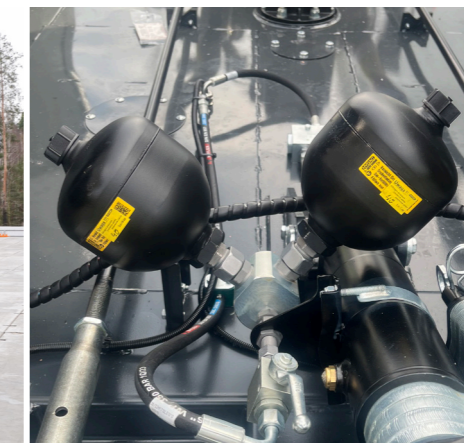
Amortisseur boule d'azote pour une meilleure stabilité lors du transport ( en option)
