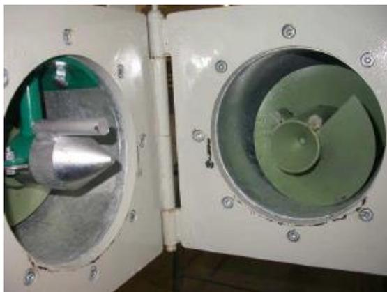
**Étape 3** | Vérifier l'alignement et l'étanchéité du joint articulé de sorte à ce que l'embrayage mâle s'insère convenablement dans l'embrayage femelle.
