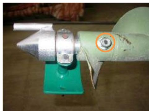
**Étape 3** | Insérer le tube intermédiaire d'une longueur de 4m et le fixer au tube précédent au moyen de 8 vis TE 8X30 et 8 écrous avec rondelle.
