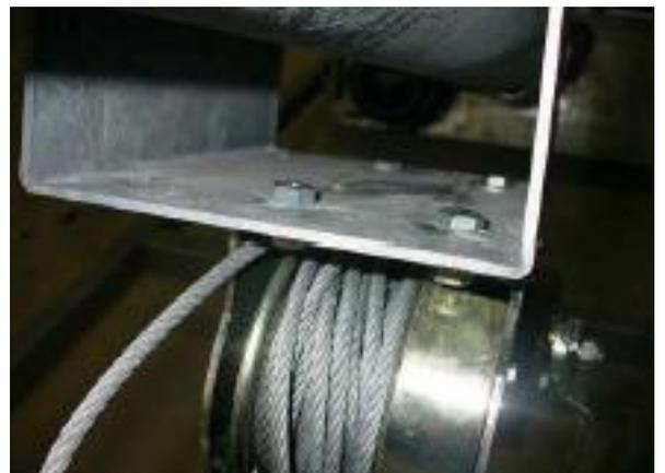
**Etape 3** | Après avoir détendu le câble en acier, faites passer le câble jusqu'au coulisseau et insérer-le dans la poulie de tête dans le sens antihoraire. (Du côté droit vers le côté gauche de la poulie)
