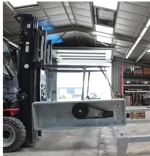
**Étape 2** | A l'aide d'un moyen de levage, disposez le pied de vis sur le châssis et fixer-le avec 2 vis TE 18X50, 4 rondelles plate Ø18 et 2 écrous de verrouillage 18MA. Veuillez à ne pas trop serrer les écrous de verrouillage de sorte à garder le bon mouvement du joint articulé.
