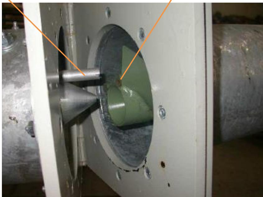
**Etape 4** | Une fois l'alignement vérifié, fermer le joint articulé avec les deux manivelles de façon à ce que les tubes ne puissent pas se séparer.
