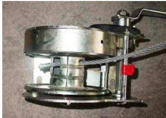
**Etape 2** | Fixer le treuil à la vis, à l'aide de 4 vis TE 10X20 et 4 écrous 10MA
