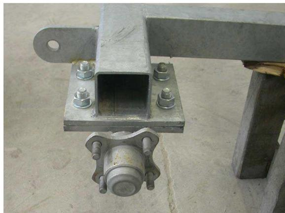
**Étape 3** | Monter les 2 roues avec les écrous à montage renversé auto centrant
