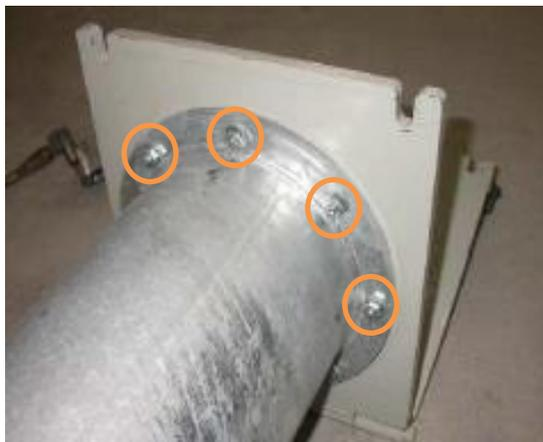
**Étape 2** | Fixer l'autre partie du joint avec le tube précédent à l'aide de 8 vis TX 8X25 et 8 écrous avec rondelle.
