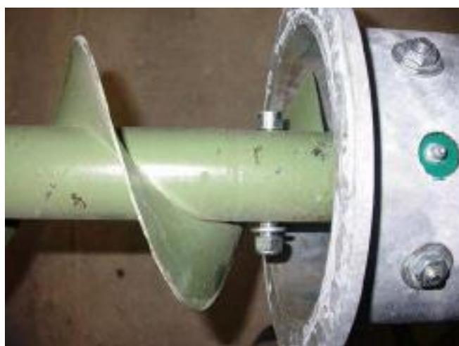
**Étape 2** | Sur l'extrémité libre de la spire intermédiaire, fixer le palier intermédiaire à l'aide d'une vis TCEI 12X80, d'une rondelle plate Ø12 et d'un écrou de verrouillage 12MA.
